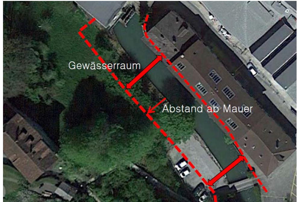
Bild 12: Beispiel für Abstände ab fixer Infrastruktur (im vorliegenden Fall eine Ufermauer)
