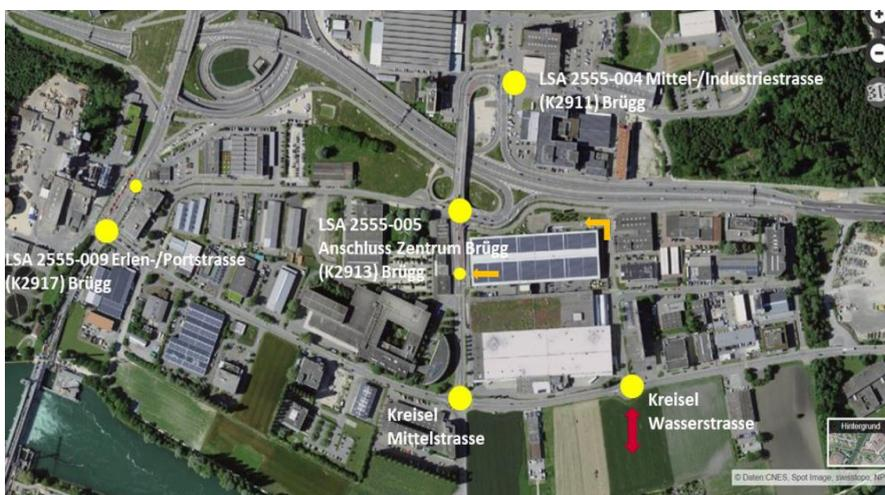
Perimeter Kapazitätsanalyse Bruggmoos: betroffene Knoten (orange: Zu- und Wegfahrt Centre Brügg, rot: Erschliessung Spitalneubau über Kreisel Wasserstrasse)
